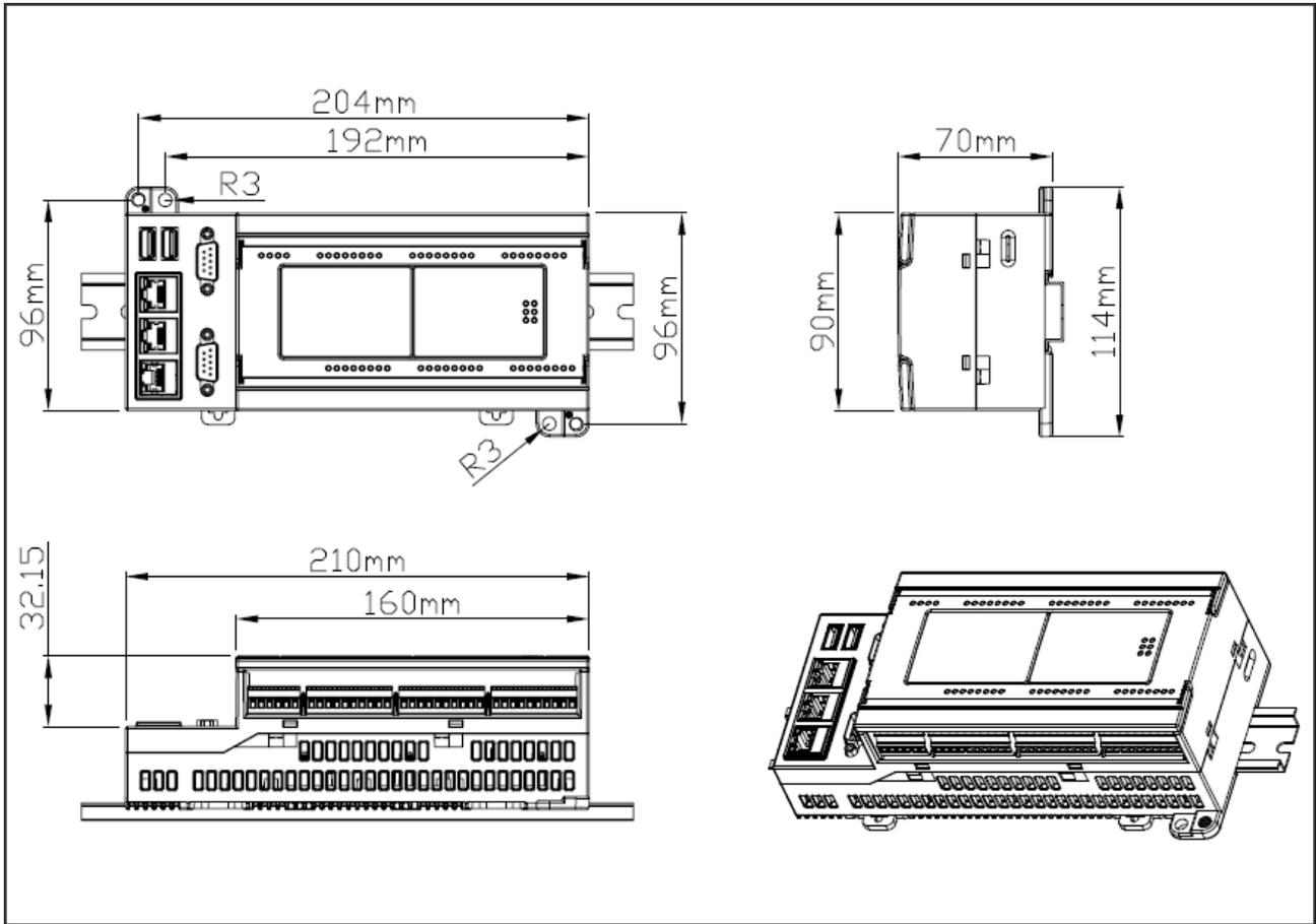
iDEABOX Pro 控制器尺寸图 单位(mm)
