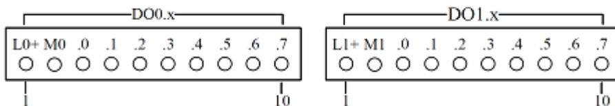
图 3-5 通用输出接口引脚定义
