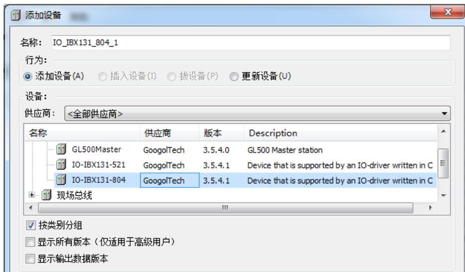
3. 添加完成后将显示在设备目录树中，如下图示。双击上一步添加的本地 IO 设备 IO\_IBX131\_804，即可进入 IO 板 Internal 配置页面。
