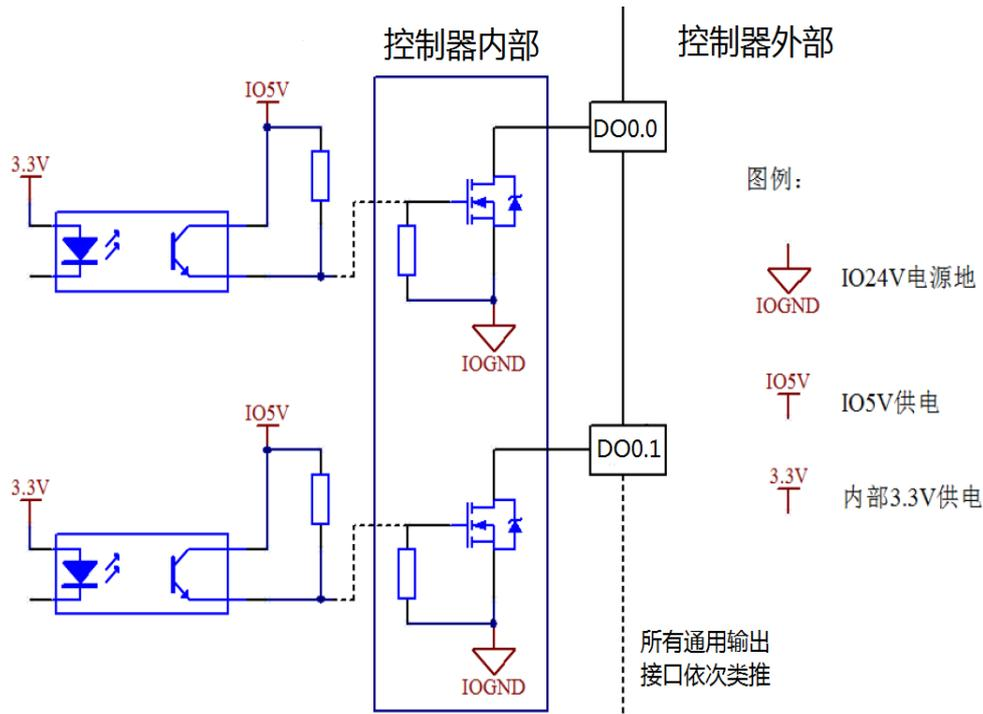
图 3-6 通用输出接口内部电路
