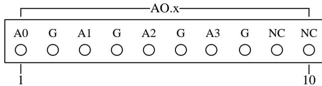
图 3-9 通用模拟量输出接口引脚定义
