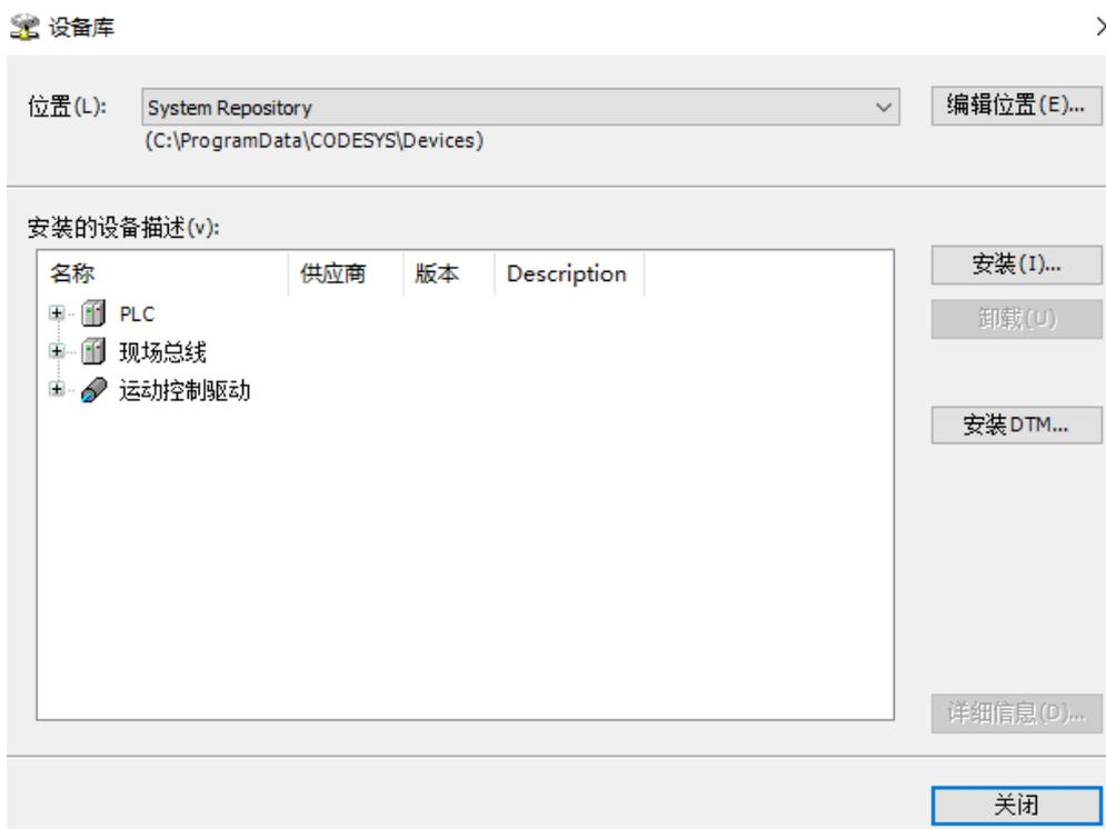
选择“安装（I）…”，在以下弹出的打开窗口中选择核心板的设备描述文件进行安装。
