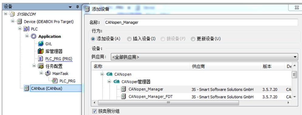
4. 在工程中选中 CANopen\_Manager 设备,可以在其下添加多个 CAN 从站设备,如本例中添加一个 SoftLink 的 CAN 远程数字量 I/O 设备“RT133\_1BL00\_CAN”。
