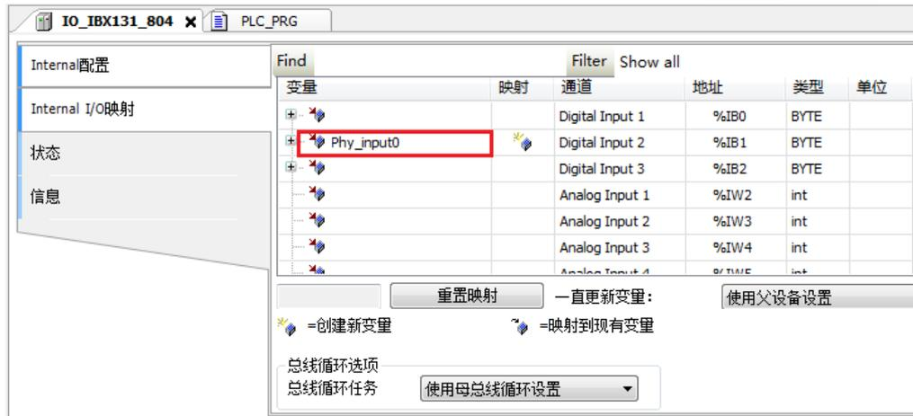
在变量中定义 Phy\_input0 变量，不需要定义变量的类型，即可在程序中调用变量。变量的操作可以按位操作，也可以按字节操作，如下图：
