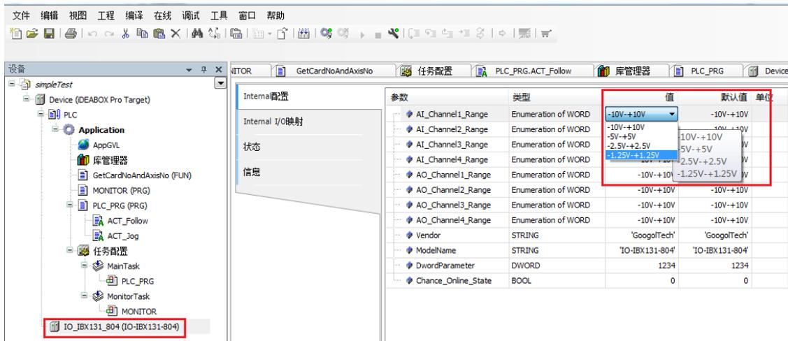
在 Internal I/O 映射中，可以查看 IO 板对应的物理地址，通道类型，也可以在变量中直接定义 IO 变量名称，方便在程序中 IO 调用。示例如下：
