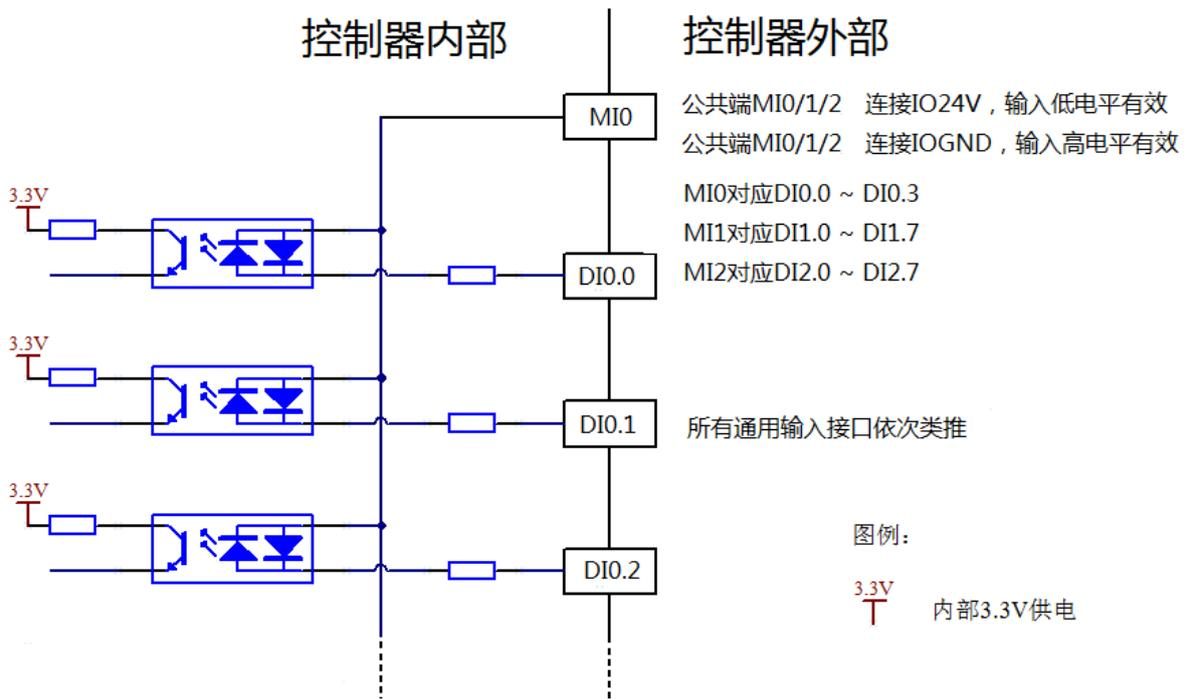
图 3-8 输入 I/O 接口内部电路
