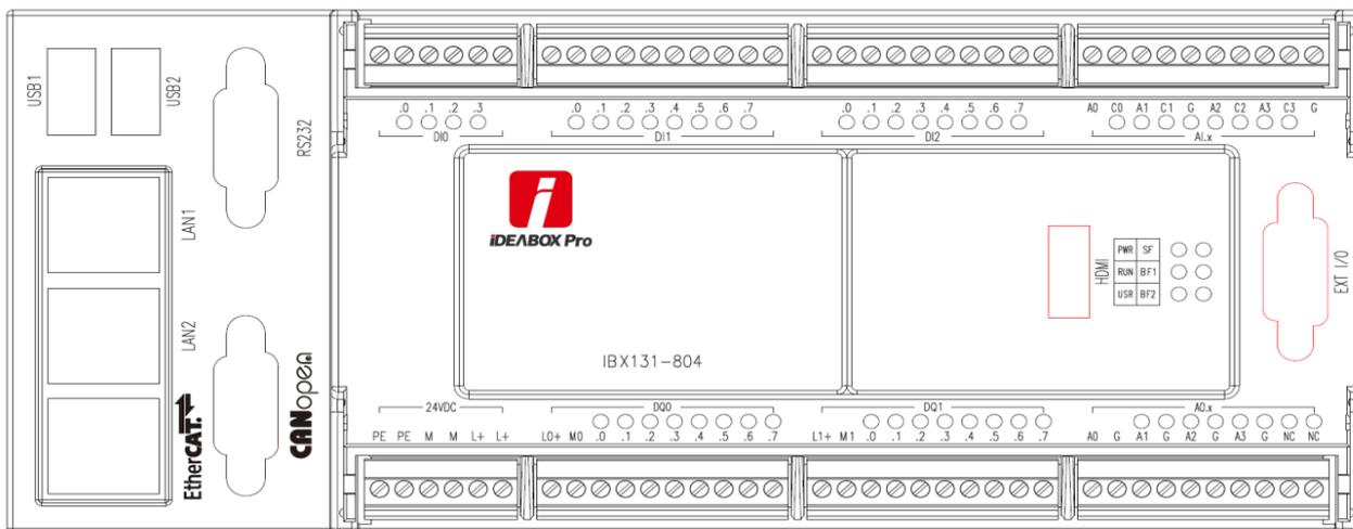
图 3-3 iDEABOX Pro 控制器接口示意图
