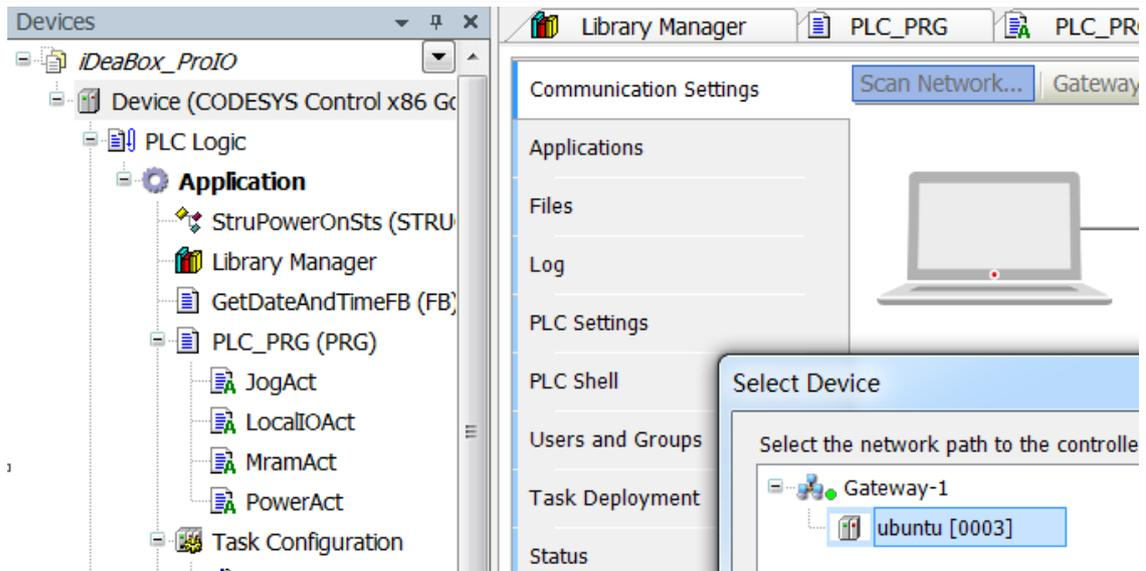
或者直接输入目标设备的 IP 地址进行连接，连接成功将会在右下角显示绿色圆圈，表示已经建立连接。
