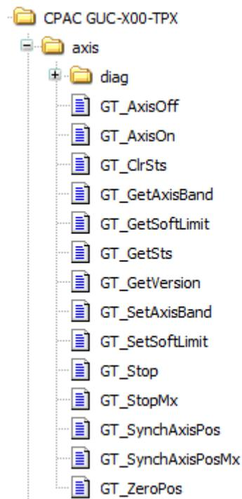
在 profile 中，包含了常用的运动控制模式操作函数，其中包括点位模式、速度模式、电子齿轮模式、跟随模式等。
