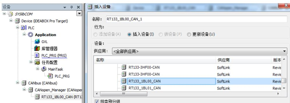
5. 双击 CANopen\_Manager 打开“概述”选项框,取消“使能心跳产生”和取消“启动同步生产”的设置,把 CANopen 总线配置为异步通信模式。
