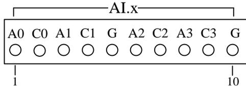
图 3-10 通用模拟量输入接口引脚定义
