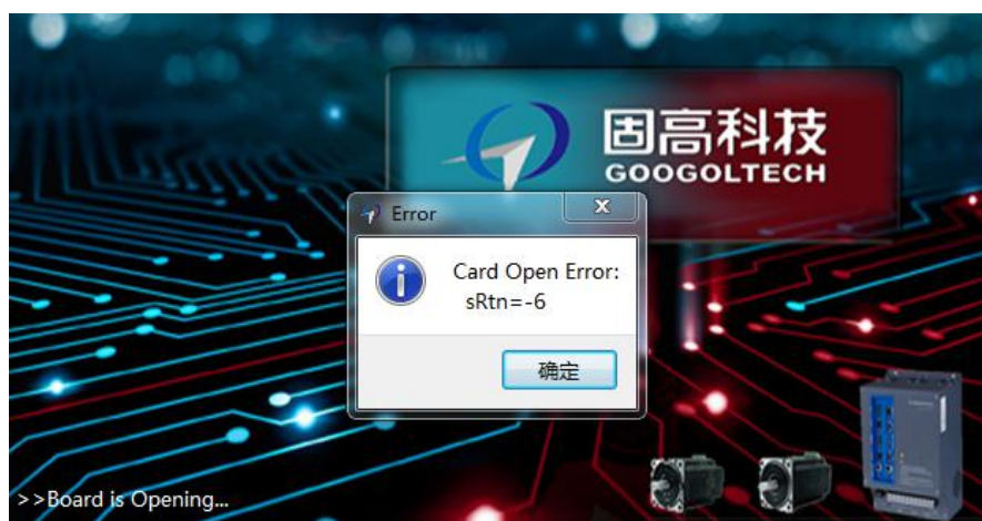
图 2-9 运动控制器打开失败界面
