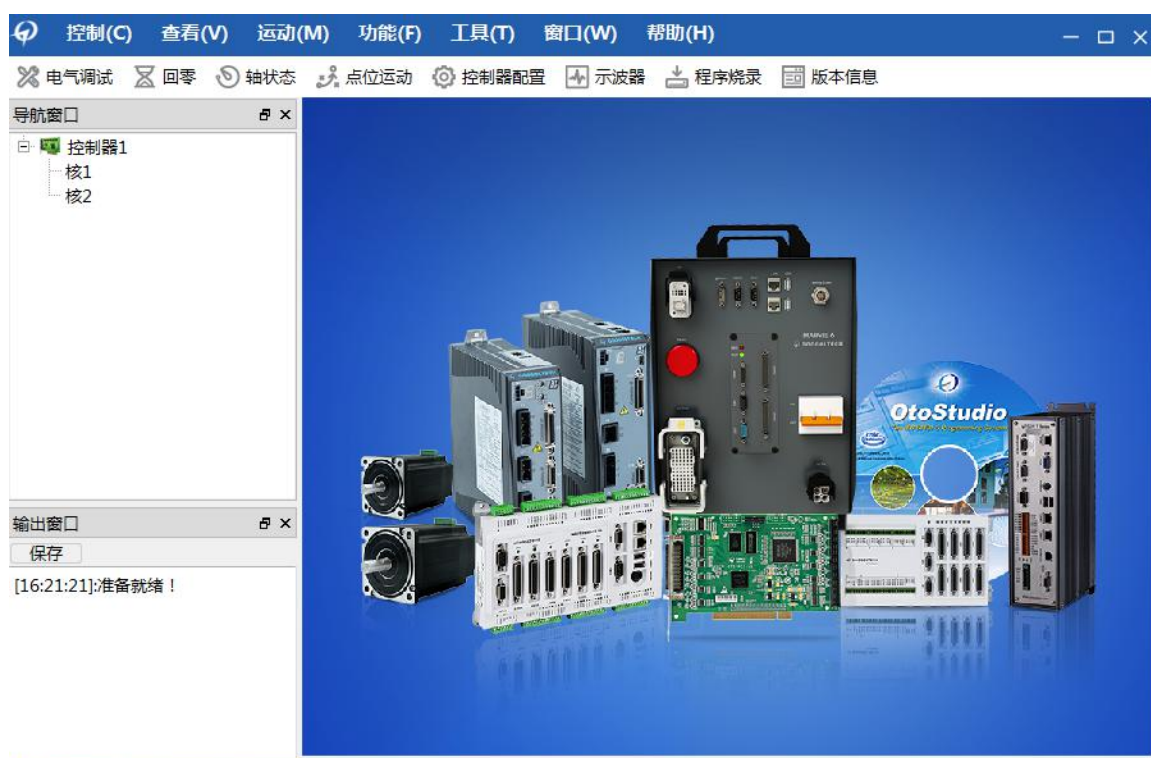
图 2-8 打开 MotionStudio 出现此界面表示运动控制器通讯正常
