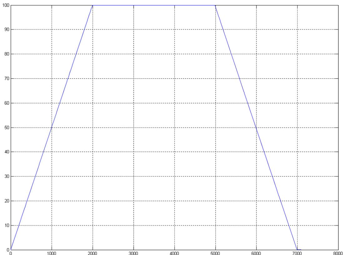
图 7-22 进行了前瞻预处理后的合成速度曲线
