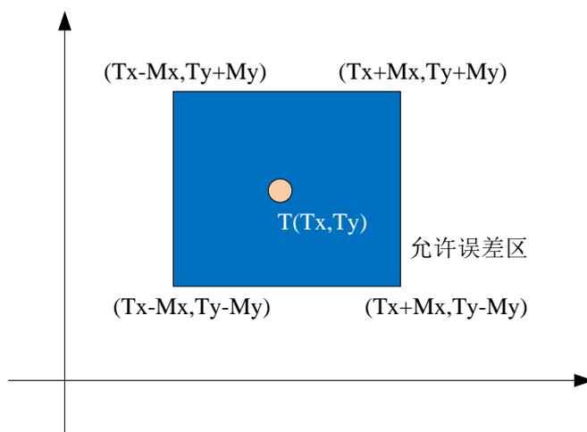
图 1 二维位置比较输出原理示意图 1
