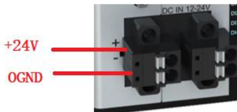
图 2-1 控制器 24V 电源接口
