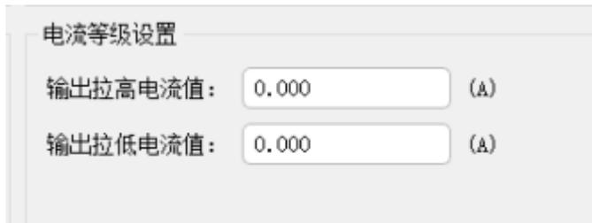
该设置是关于数字量 I/O 输出中的“电流等级”的设置。当电流升高至“输出拉高电流值”时，“电流等级” I/O 输出；当电流降低至“输出拉低电流值”时，“电流等级” I/O 不再输出。
