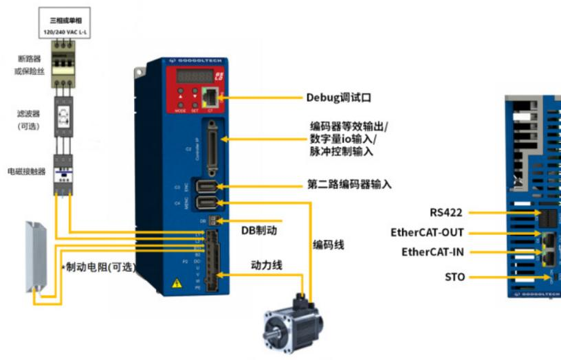
图 2.1.2 驱动器接线图
