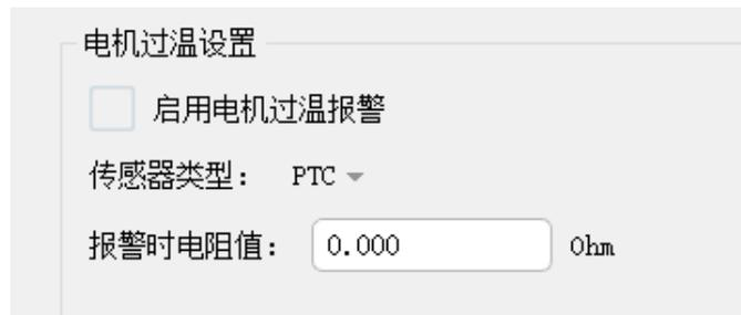
GSLD 通过接热敏电阻来获得电机温度的模拟量信号
