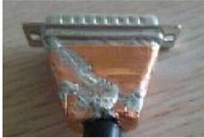
2) 使用塑胶外壳的 DB 头：两端铜箔要全包围（不能漏内模），加锡要分散编织，所有结合处要完全跑到锡，如下图所示：
