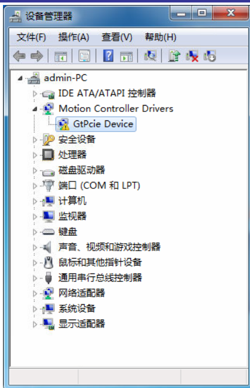
图 2-8 控制器驱动需要安装系统补丁界面
