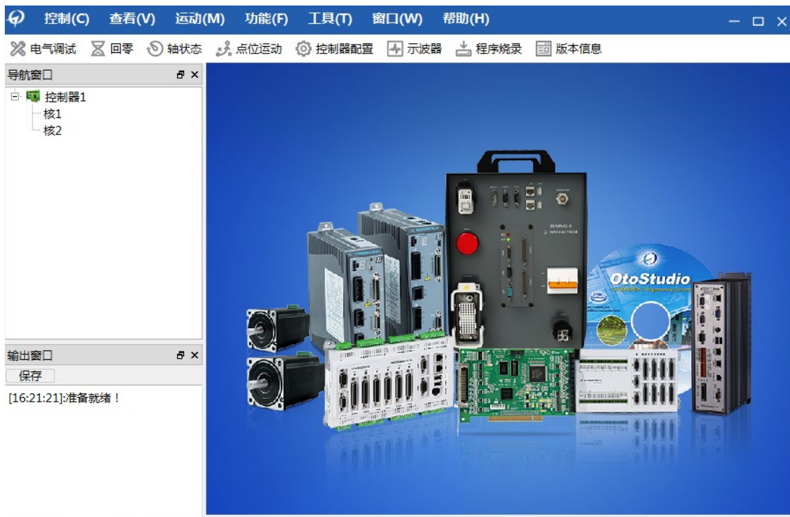
图 2-9 打开 MotionStudio 出现此界面表示运动控制器通讯正常
