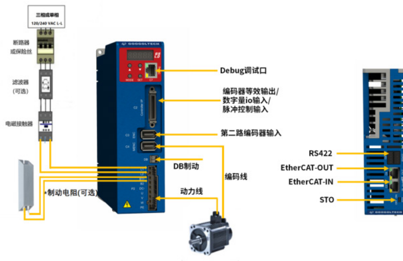
图 2.1.2 驱动器接线图
