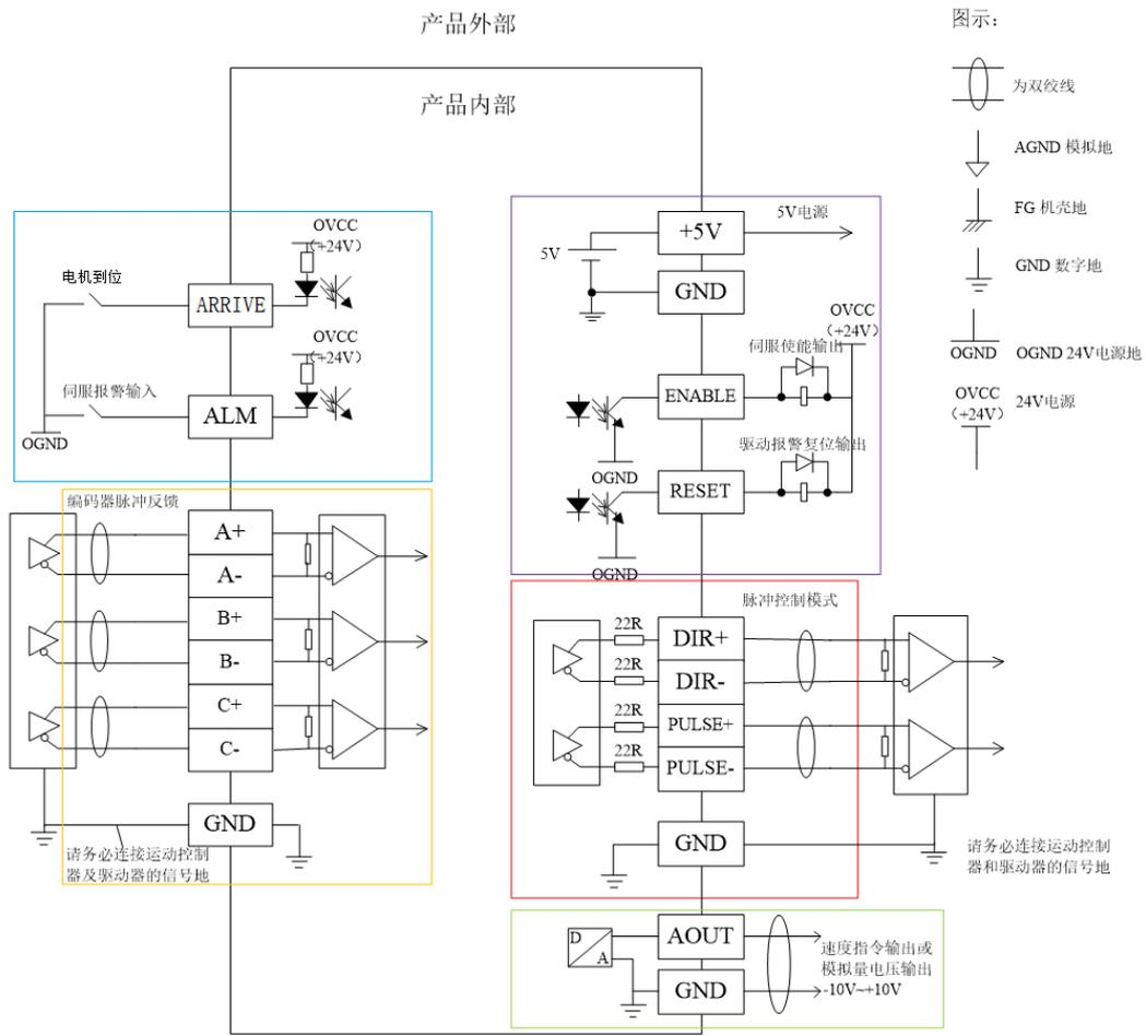
图 3-15 模块轴信号接口内部电路
