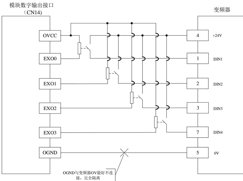
图 4-2 数字输出接变频器连接方式
