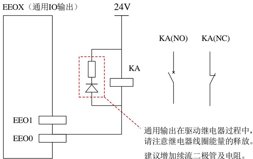
图 4-3 通用输出接继电器
