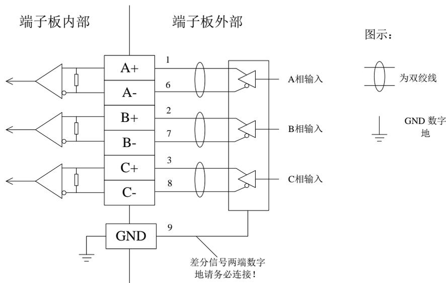
图 3-16 模块辅助编码器接口 (ENC) 内部电路
