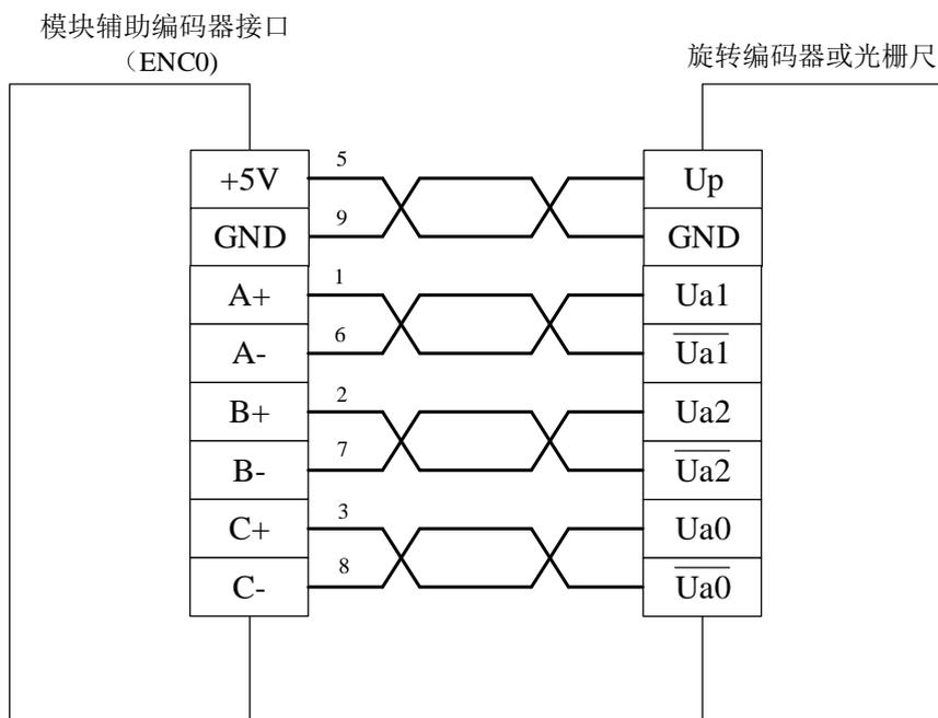
图 4-4 接海德汉旋转编码器
