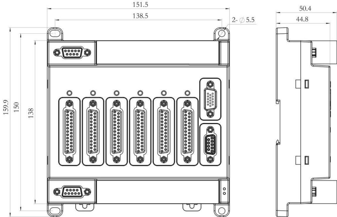
图 6-1 塑胶外壳尺寸图 单位 (mm)
