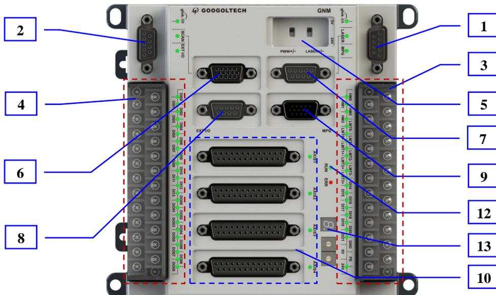
图 3-10 GNM-403-XX 接口示意图（带灯板和站号）
