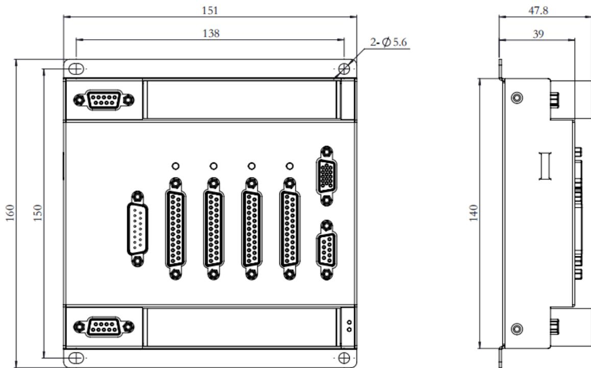
图 6-2 金属尺寸图 单位 (mm)
