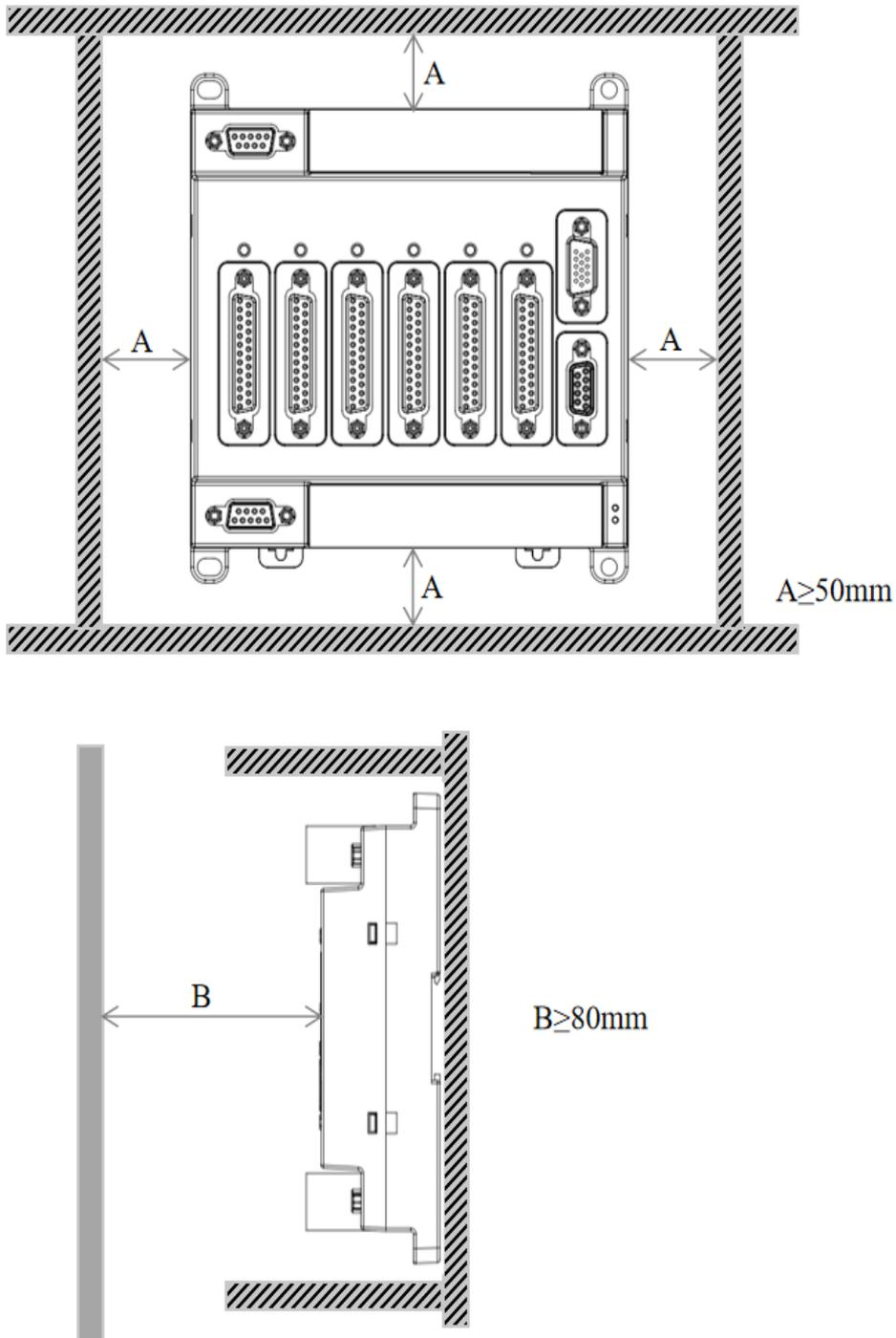
图 6-3 模块装配尺寸图 单位 (mm)
