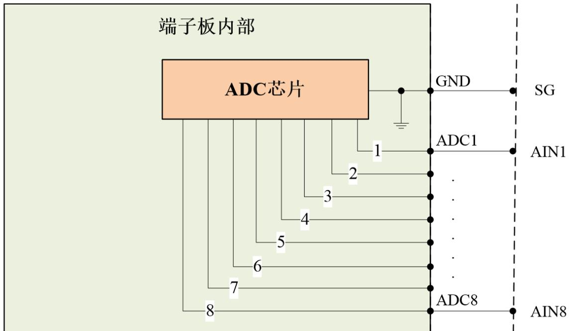
图 3-17 模块模拟量输入内部电路示意图
