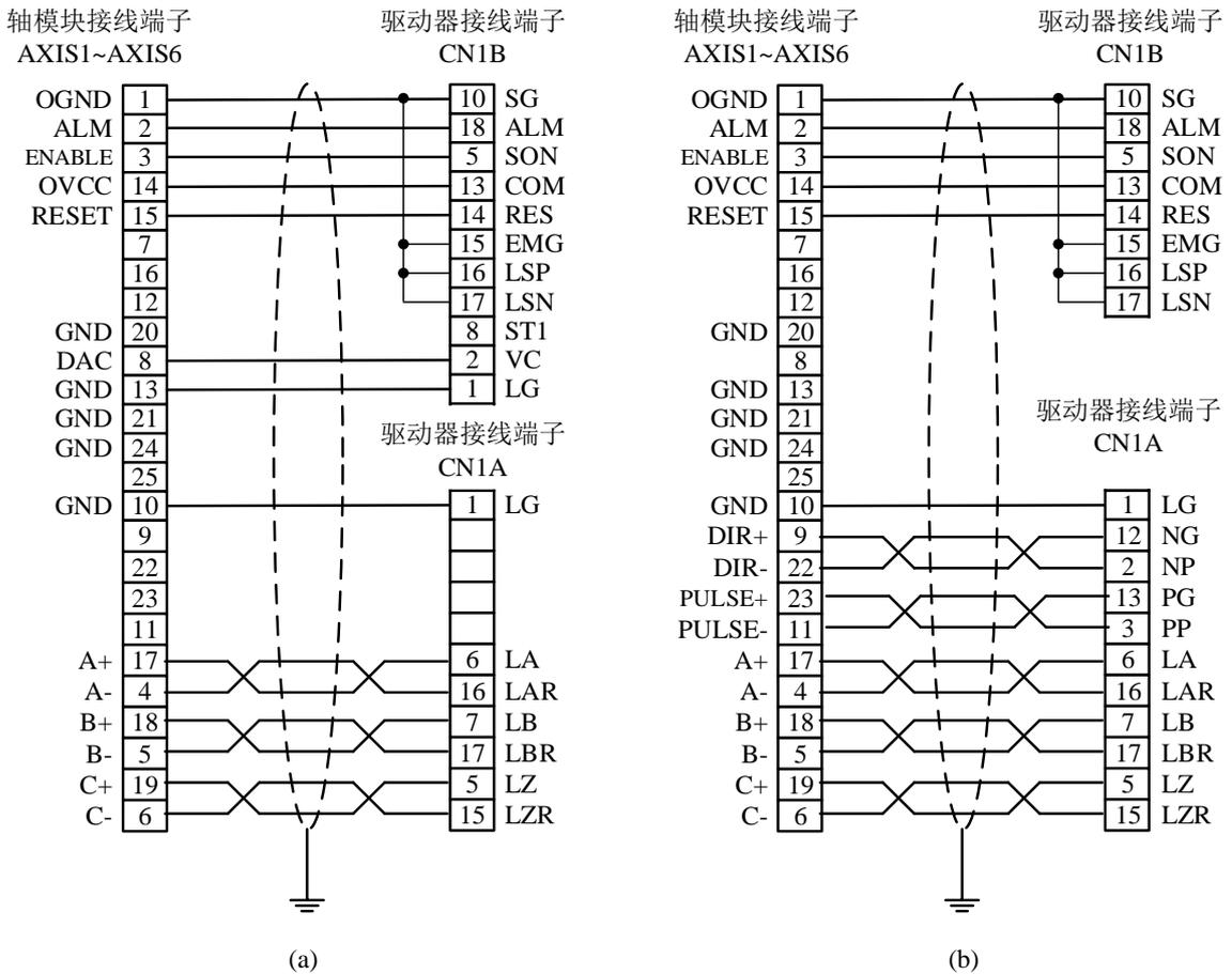
图 5-11 三菱 MELSERVO-J2-Super 系列驱动器速度控制方式(a)、位置控制方式(b)接线
