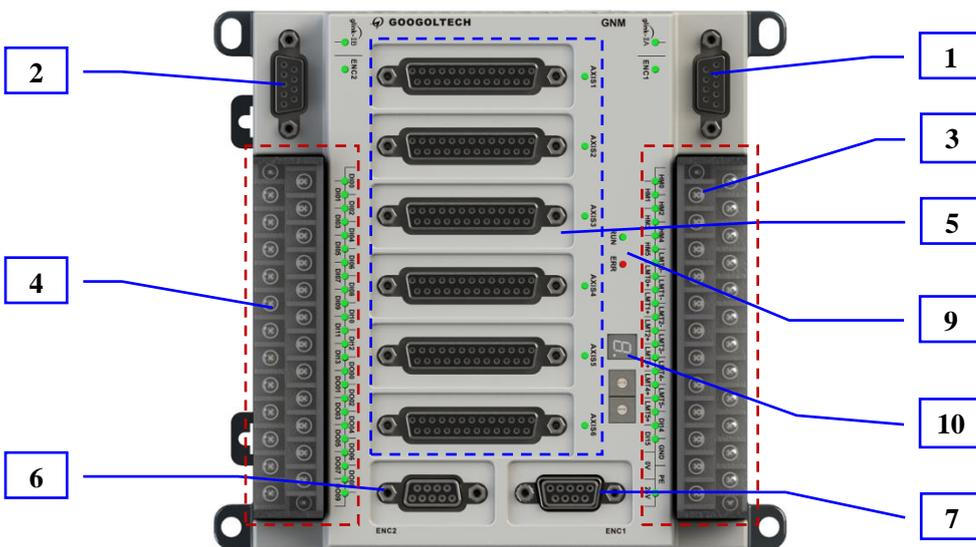
图 3-4 GNM-602-XX 接口示意图（带灯板和站号）
