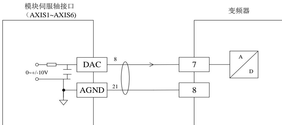
图 4-1 模拟量控制变频器接线方法
