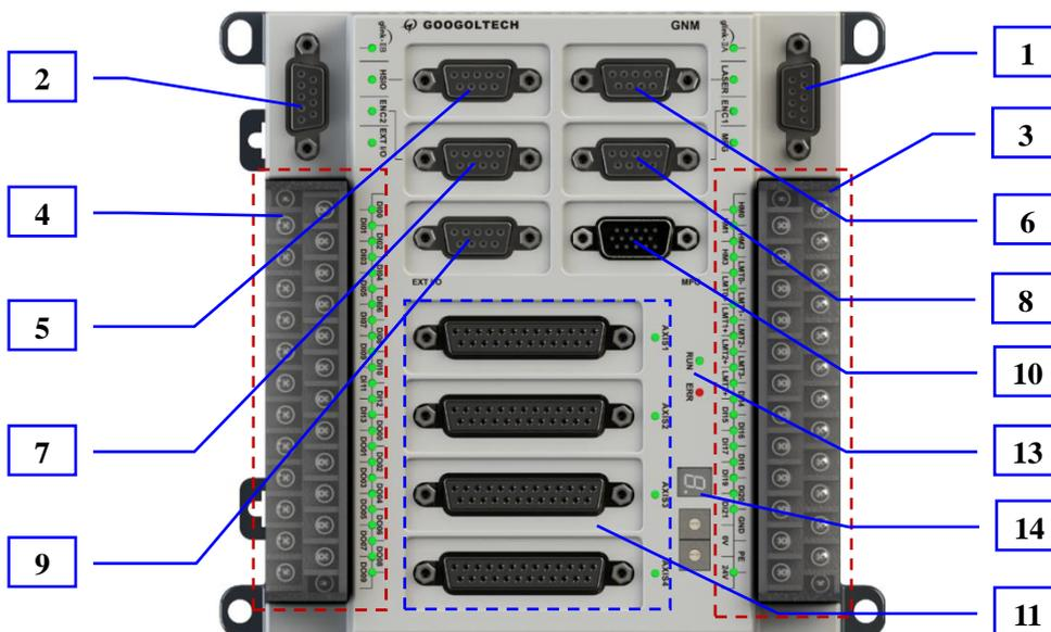
图 3-8 GNM-402-XX 接口示意图(带灯板和站号)
