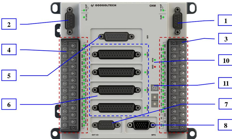
图 3-6 GNM-401-XX 接口示意图(带灯板和站号)
